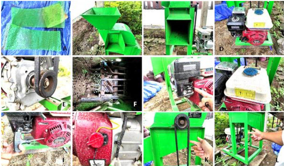
Gambar 3. Komponen mesin chopper yang terdiri dari (A) saringan (B) Hopper (C) Corong output (D) Motor bensin (E) Pulley (F) Pisau Penghancur (G) Tuas bahan bakar (H) Tangki bahan bakar (I) Handle Penarik Gas (J) Tombol Power (On/Off) (K) V-Belt dan (L) Rangka Mesin.
